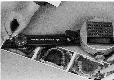
図1：面積・外周測定用のエリアカーブメーター
