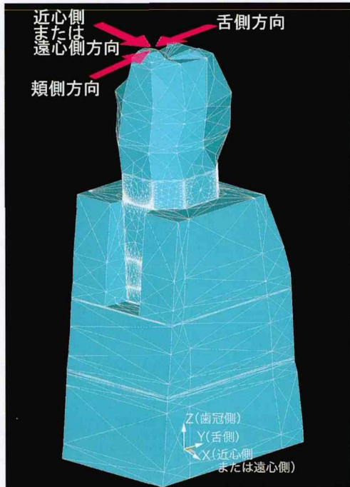
図3: 三次元有限要素モデルにおける荷重方向
