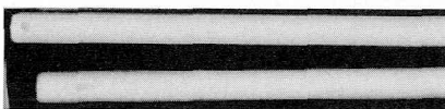
図 1: 引張試験, 曲げ試験に用いた鋳造体の X 線写真 (直径 2.0 mm)
