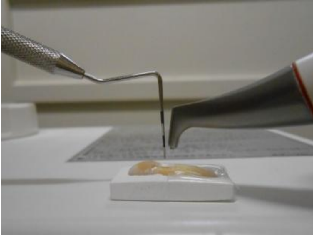
図1：対象となる抜去歯牙とエアフローSII（新規群）噴射設定
