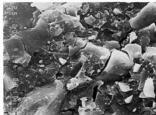
図9：試料Fの試験片作製7日後の破断面
