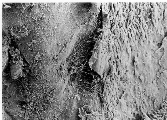
図3-c 対照群（ブラシコーンによる清掃後）の裂溝底部SEM像（×480） （有機性残留物等の構造物、糸状菌様物質が認められる。）
