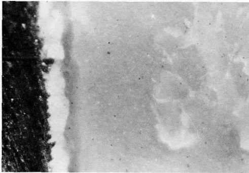
図10：図9の拡大像。ハイドロキシアパタイト溶射の表面はかなり粗造で、一部では溶解したかのような像も認められる。
