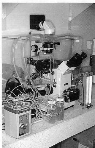
図10：16 mm 顕微鏡映画撮影システム 位相差顕微鏡の前面に設置されている培養液の貯蔵ボトルは、図11に示されるローズチャンバーに接続され、その中で培養される骨組織の変化を撮影することが可能である。
