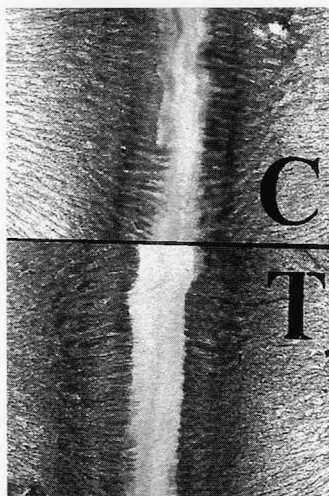
図19：拡大前の縫合部（上段C）と拡大後の縫合部（下段T）の実体顕微鏡像
