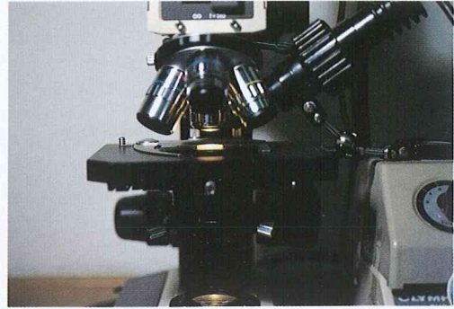
図4：分光透過率の測定は、オリンパス社製金属顕微鏡において、試料の下方から光を照射した。
