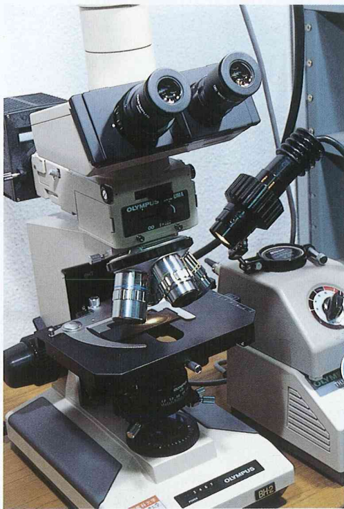
図3：分光反射率の測定は、オリンパス社製金属顕微鏡において、試料の斜め45度上方から光を照射した。
