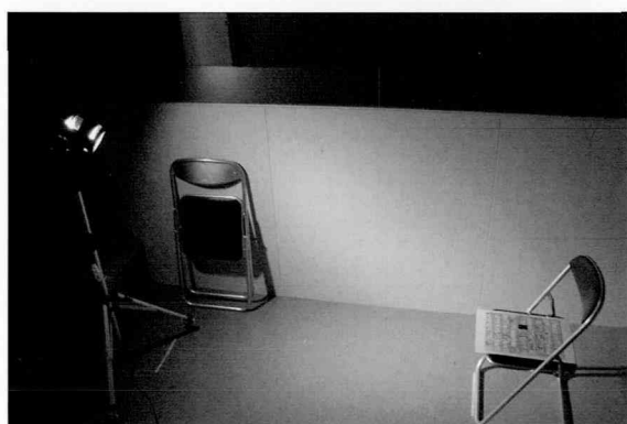
図8: 人工太陽照明灯 (SOLAX XC-100 セリック)
